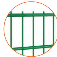
Panneau rigide double fil Ø 6/5/6 mm ou Ø 8/6/8 mm Maille 200 x 50 mm
