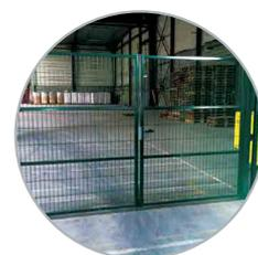
Existe aussi en remplissage treillis soudé par points mailles 50/50 fil de Ø 5mm
