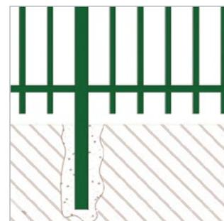
Il est conseillé de prévoir les scellements d'une profondeur de 500 mm.
