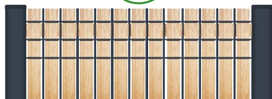
**4** Fixer les lattes verticales sur les trapèzes à l'aide d'une agrafe de 14 mm minimum ou d'un clou de 15 mm minimum. Fixer les lattes en un seul point permet de laisser le bois travailler.
