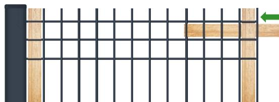
**2** Placer les trapèzes dans le pli du panneau, en haut et en bas, sous la latte verticale (les trapèzes doivent venir en butée dans les poteaux).
